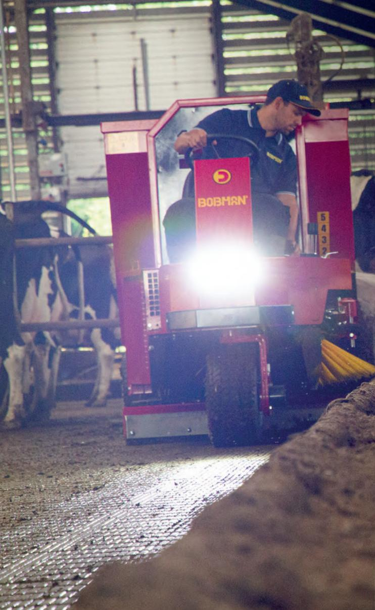
Der BOBMAN Comfort ist eine selbstladende Einstreumaschine, die speziell für das Aufbringen von schwerem oder feuchtem Einstreumaterial in Rinderliegeplätzen entwickelt wurde, z. B. von separierten Güllefeststoffen (*grüne Einstreu*), Torf, anorganischer Einstreu (*Kalk usw.*) oder einer Mischung aus organischer Einstreu (*Stroh, Sägemehl*) mit Kalk und Wasser in Freilaufställen mit Tiefstreu.
