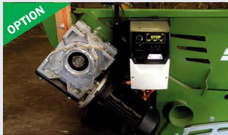
**Elektrischer Antrieb** 2.2kW Getriebemotor mit Frequenzumrichter stufenlos verstellbar Für stationären Betrieb in Scheune/Heuboden
