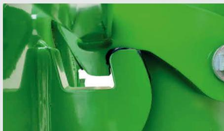
Patentiertes System zum automatischen Verbinden/Trennen. Beseitigt das mühsame Ziehen am Seil zum Trennen der Maschine
